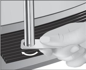
► Schrauben Sie die beiden Metallrohre der Profi-Dampfplanze mit Hilfe der beiden Schlüssel auseinander.
