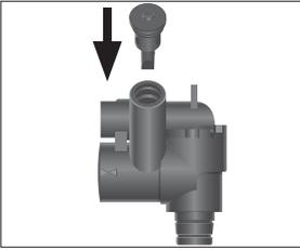
► Setzen Sie den Luftansaugstutzen ein.
