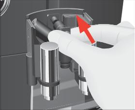
► Réinsérez les pièces constitutives réassemblées dans l'écoulement combiné et enfoncez-les fermement.
