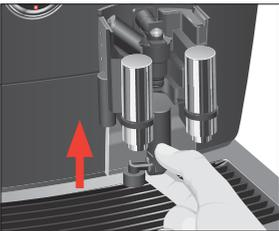
► Insérez la partie inférieure du système de lait par le bas dans la partie déjà en place.
