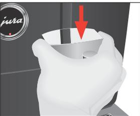
► Remplacez le couvercle de l'écoulement combiné. Il s'enclenche avec un clic audible.
