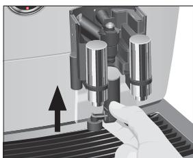
▶ Encaixe a parte inferior do sistema de leite por baixo, na parte já colocada.
