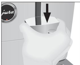
▶ Coloque a tampa da saída combinada. Ouve-se a tampa encaixar.
